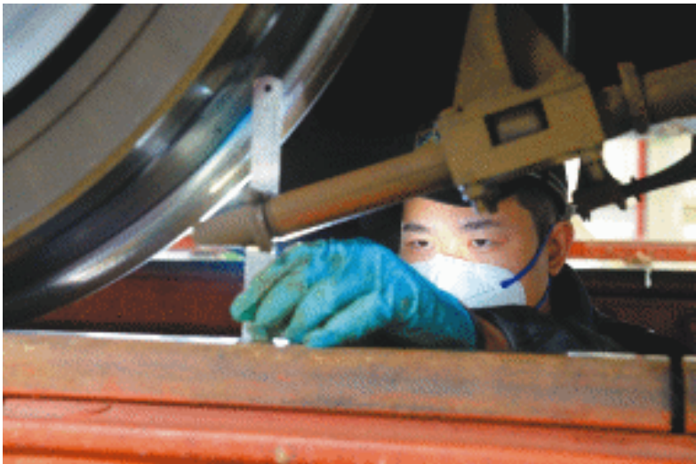
22日晚12时,机械师在地沟里检修车轮,用标尺测量间隙。
