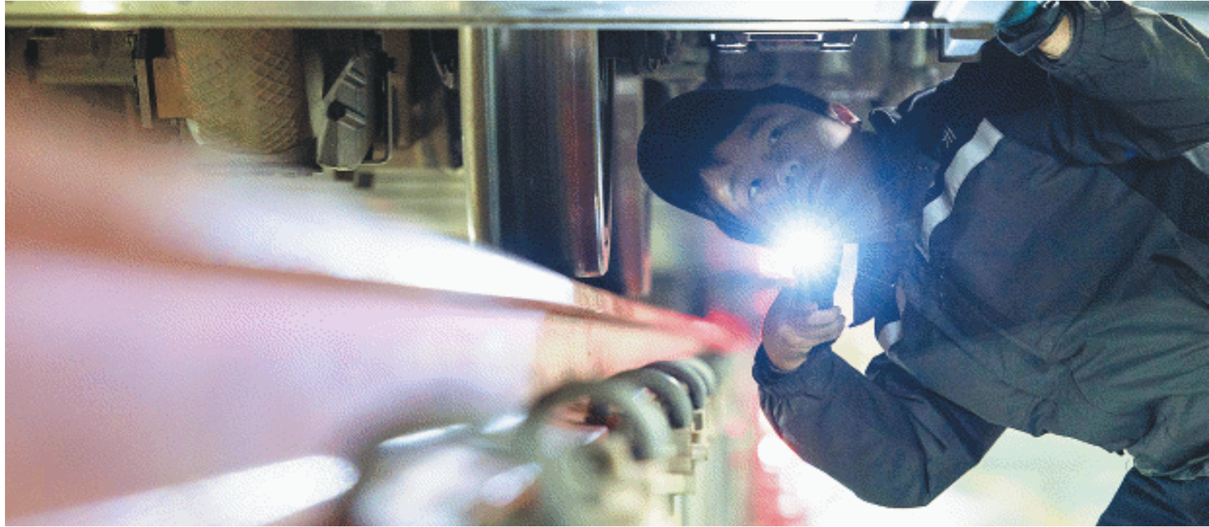
22日晚11时,机械师正在给“复兴号”列车执行两厢作业,在底盘下检查裙板和零部件是否状态良好。
