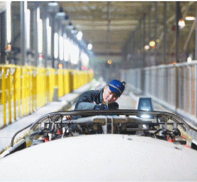
22日晚,机械师爬上动车组列车的车顶进行检修。
